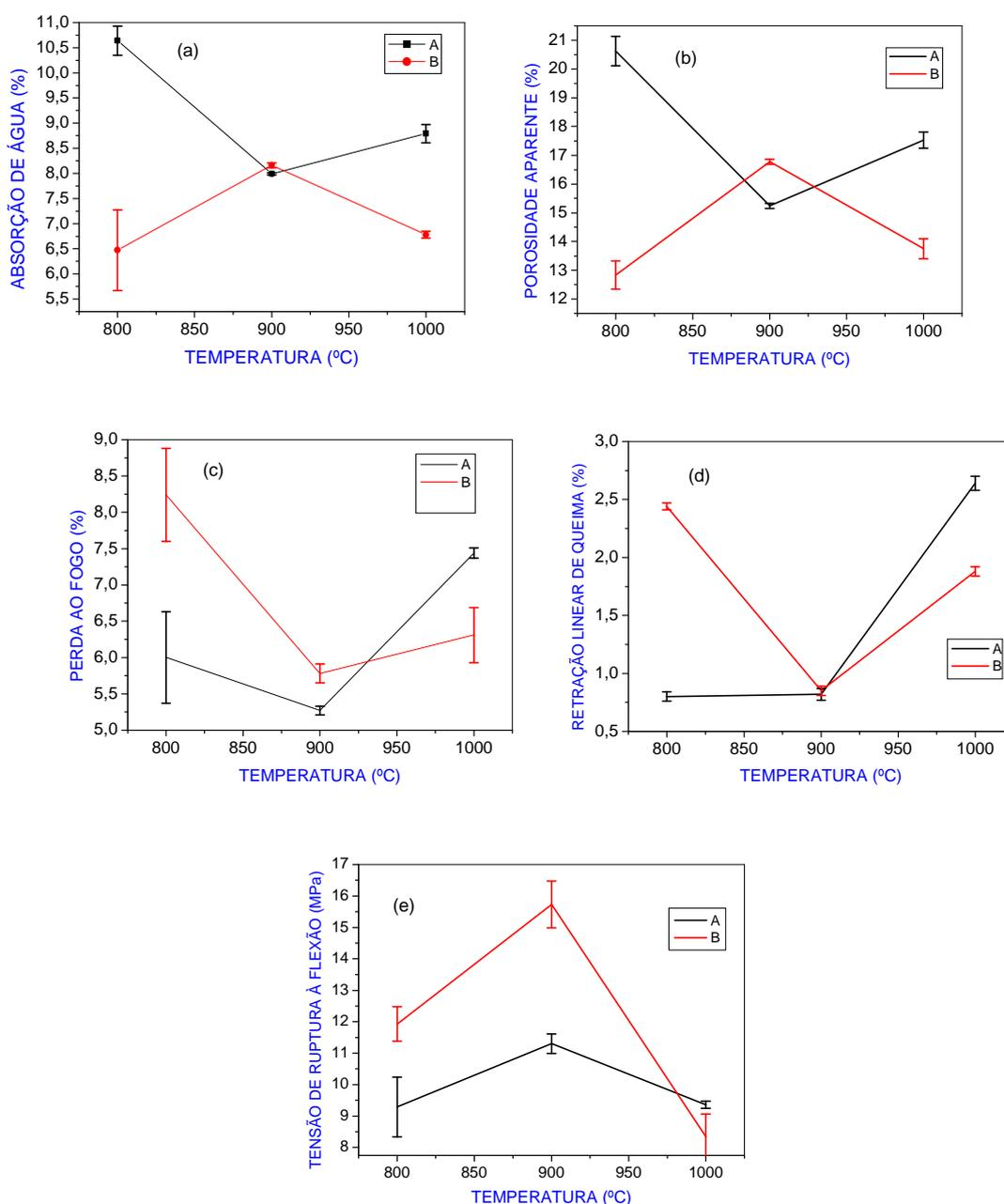
Figura 2: Absorção de água (a), porosidade aparente (b), perda ao fogo (c), retração linear de queima (d) e tensão de ruptura à flexão (e) dos corpos de prova extrudados e sinterizados em função das temperaturas de queima.
